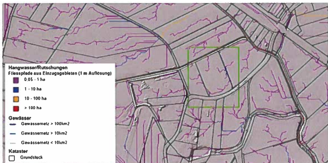
Oberflächenwasserabfluss (Fließpfade), Quelle: GIS Steiermark
